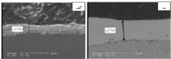
شکل ۴. تصاویر میکروسکوپ الکترونی روبشی پوشش‌ها در (الف) کاربید تنگستن-کبالت (ب) استلایت ۶.
