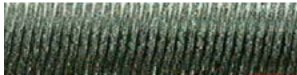
شکل ۴: تصویر VMM برای سرعت برشی ۱۰۰۰ و سرعت پیش‌روی ۰/۰۸
