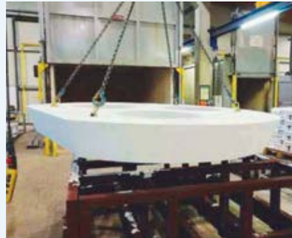
سقف یکپارچه ریخته شده با جرم‌های مبتنی بر سیستم هیبریدی؛ این سقف تنها با چهار قلاب فولادی جابجا می‌شود.
