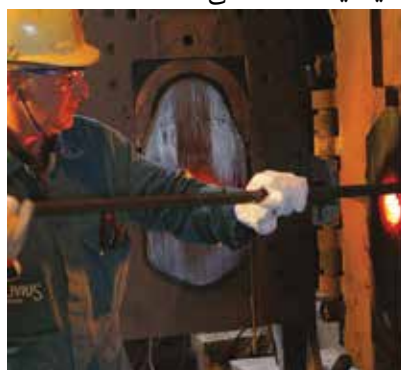
شکل ۴: بررسی صفحات اسلاید گیت توسط نسوزکار پاتیل (۶)
