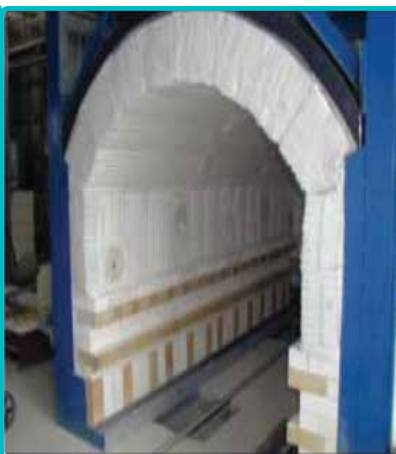
کوره نصب شده در ایران با استفاده از پتوی فشرده
