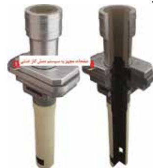
شکل ۱: نحوه مونتاژ صفحات اسلاید گیت و نازل‌ها در کف پاتیل‌های فولادسازی (۶)
