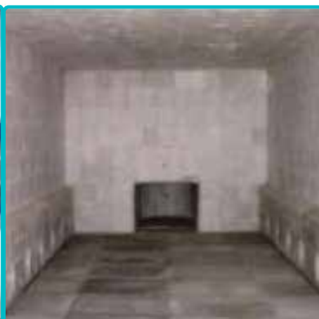
کوره بسته با استفاده از مدول از پتوهای سرامیکی
