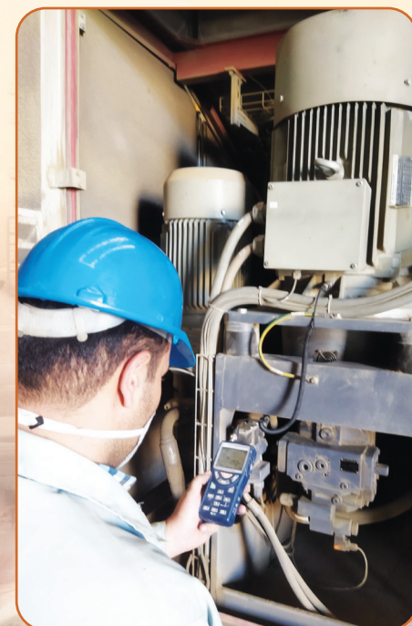
اندازه گیری ارتعاش بلبرینگ الکتروموتور ۵۵ کیلو وات پرس لایس
