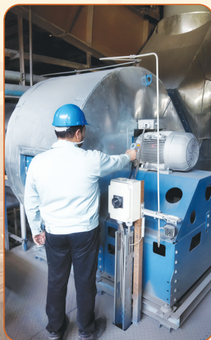
پایش دما الکتروموتور هوای زیر سقف (روف) کوره ریدهامر
