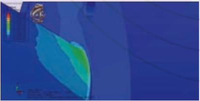
شکل ۱۰– تنش های وارده به شافت و غلطک با یاتاقان سمت راست معیوب
