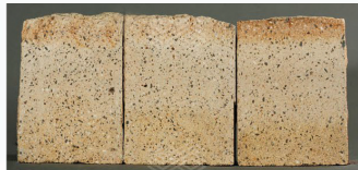
شکل (۴) مقطع برش خورده آجر آلومینوسیلیکاتی در منطقه ایمنی کوره
