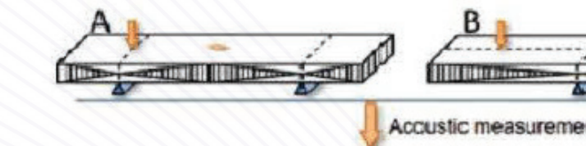
شکل ۱: شمش مستطیلی مورد آزمون در حالت پیچشی (A)، حالت خمیده خمشی (B) و حالت طولی (C)
