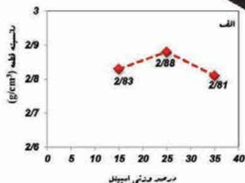
شکل ۴- الف) چگالی نمونه های منیزیا حاوی ۱۵، ۲۵ و ۳۵٪ اسپینل. ب) درصد تخلخل ظاهری نمونه های منیزیا حاوی ۱۵، ۲۵ و ۳۵٪ اسپینل.
