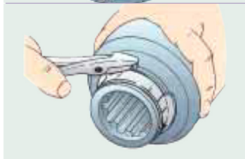
شکل ۳: مراحل اندازه گیری و نصب بوش تعمیری بر روی شفت
